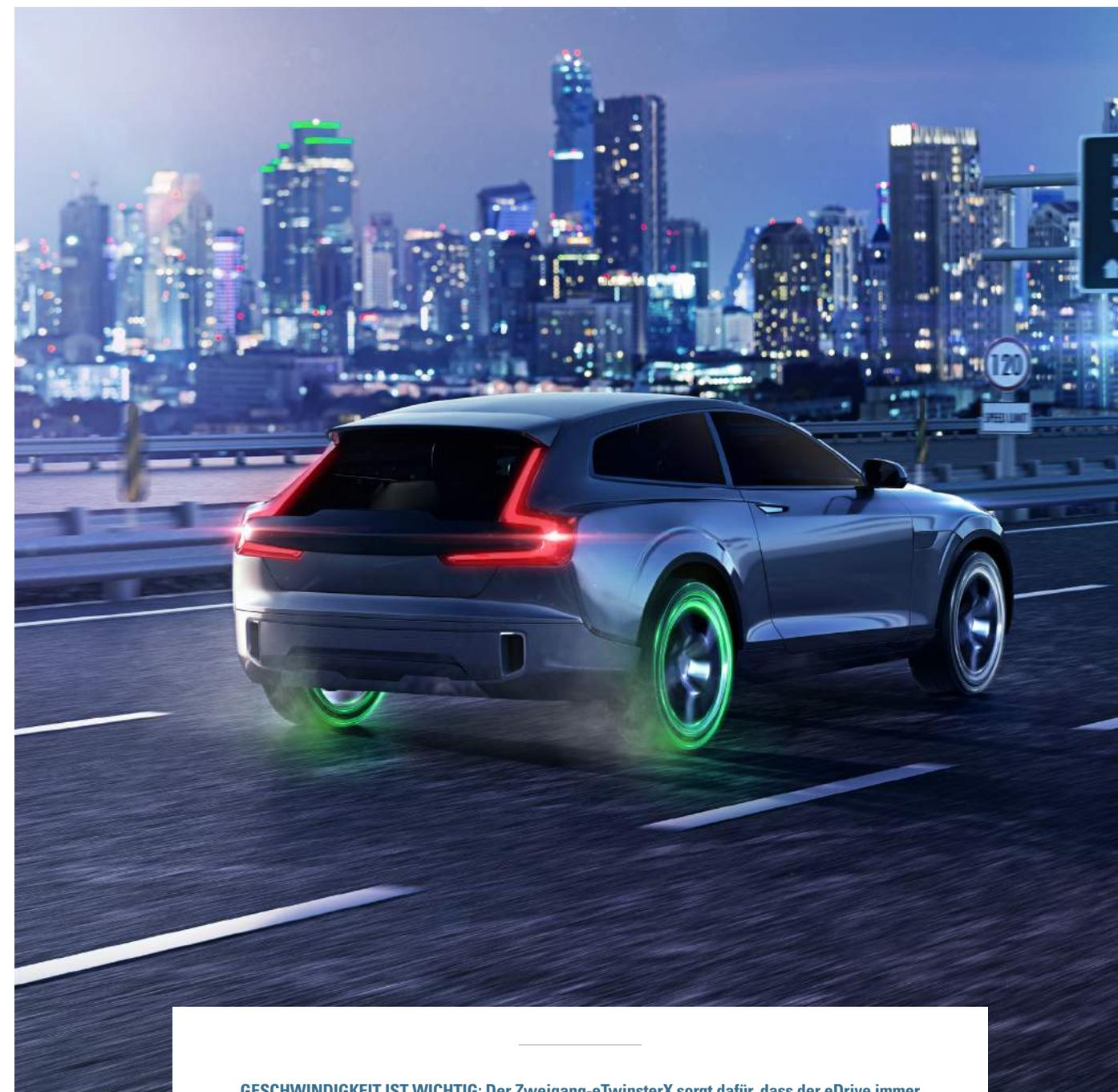
**GESCHWINDIGKEIT IST WICHTIG: Der Zweigang-eTwinsterX sorgt dafür, dass der eDrive immer nutzbar ist und ermöglicht dem Fahrzeug, die Bremsenergie auf der gesamten Geschwindigkeitsbreite zu rekuperieren. Eingang-eDrives müssen bei 120 km/h abschalten, das bedeutet, dass über diesen Punkt hinaus keine kinetische Energie mehr rückgewonnen werden kann**
